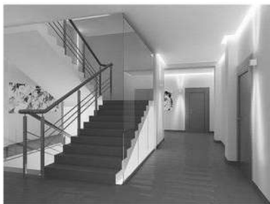
Эвакуационная лестница 2-го типа (справа)
